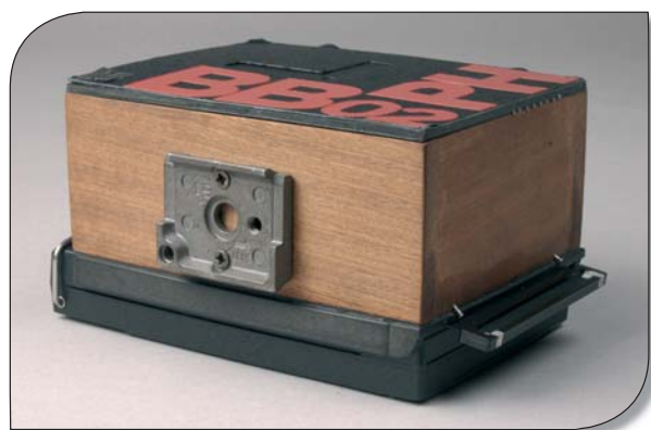
Il problema di come controllare "a vista" il decentramento è stato risolto in modo elementare quanto brillante: Beppe Bolchi ha inserito due spilli sul dorso della fotocamera (contrassegnati con la lettera "B") e una serie di sette spilli sulla parte frontale (indicati dalla lettera "A"). Un elastico teso tra gli spilli permette di capire immediatamente il decentramento impostato: A1 corrisponde a decentramento a zero, A2 al decentramento massimo. Vi sono poi altri sette spilli sul lato inferiore della fotocamera (non visibili in questa immagine) che servono per controllare i decentramenti sull'altro asse. La linea gialla in corrispondenza degli spilli corrisponde al decentramento impostato.
