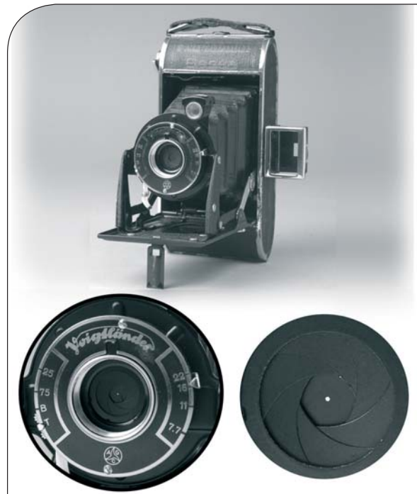
Una vecchia Voigtlander Bessa a cui è stato sostituito il gruppo ottico con un PinHole. La posa T dell'otturatore sarà providenziale per gestire le lunghe pose. Il soffietto, che in origine serviva per la messa a fuoco, si trasforma qui in un variatore di focale: in pratica la vecchia Bessa è diventata una fotocamera PinHole zoom!
